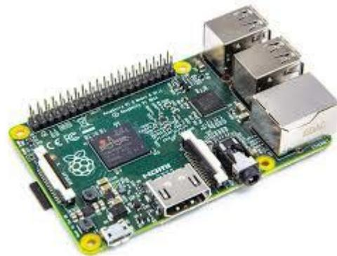
Fig. 2: Raspberry pi 2 model B
